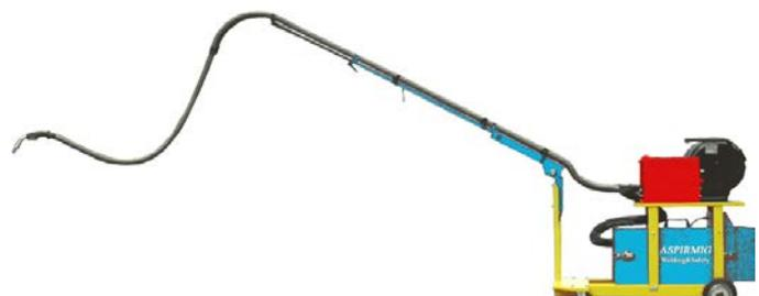
Zentralisierte Anlage mit der Möglichkeit bis zu 12 Schweißbrenner anzubringen (100%-ige Gleichzeitigkeit). Sie wird komplett mit allen Anlagenteilen geliefert, die für die Inbetriebnahme notwendig sind, sowohl für die automatische als auch für die handbetriebene Version.
