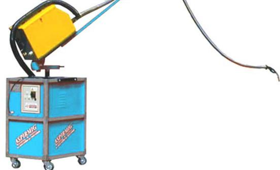
Generatoren mit unterschiedlichen Modellen, ausgerüstet mit ausgewogenem Auslegerarm sowohl mit Brennerhalterung als auch mit Drahtführungshalterung. Arbeitsfeld 8-9m
