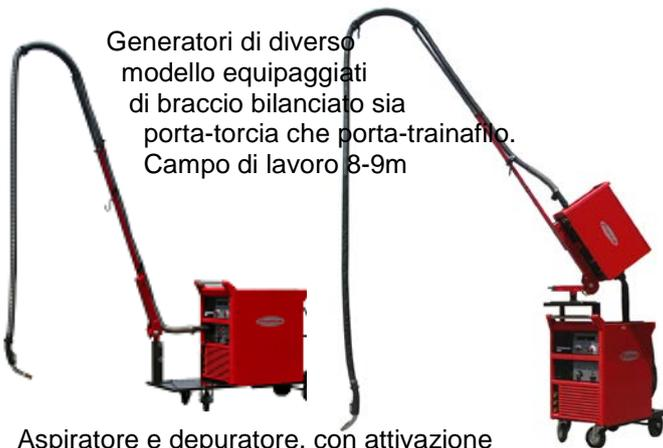
Aspiratore e depuratore, con attivazione Automatica, (1-2 motori) equipaggiabile sia con dispositivi di captazione a base magnetica oppure con maschera aspirante.
