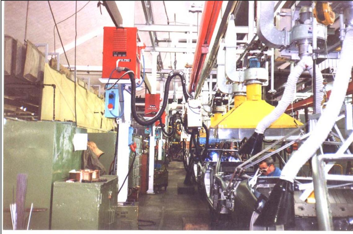
Attrezzamento di un reparto per la saldatura di scocche per automobile, dove l'unità è installata a pilastro mentre il traina filo é montato su monorotaia per accompagnare l'avanzamento della linea skate a pavimento.
