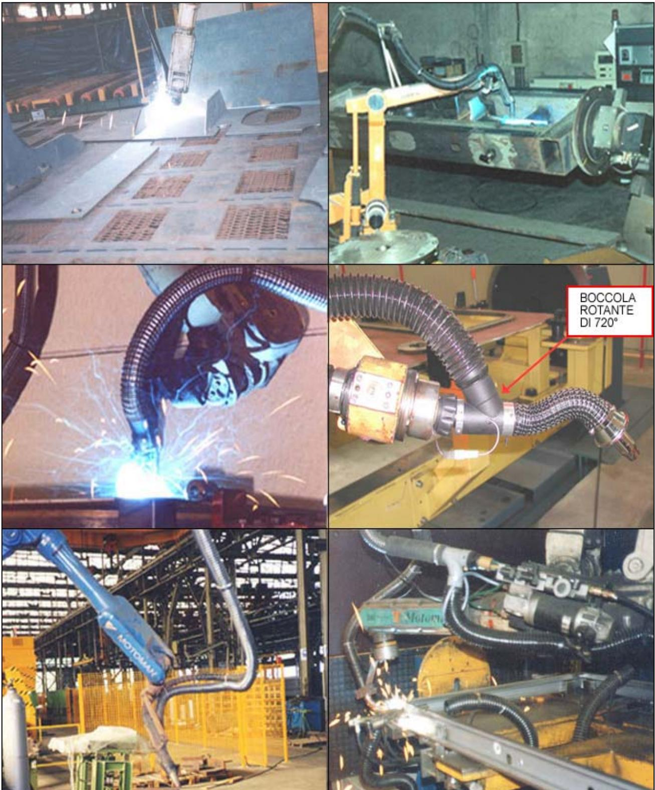
Esempi di applicazione e di sorprendente praticità, della torcia con l'aspirazione integrata dei fumi su processi di saldatura robotizzata di svariate case: Motomann, Igm, Fanuc, Asea.
