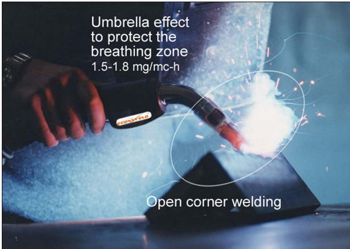
Qui sopra si può verificare l'efficienza di captazione della torcia **ASPIRMIG** nella posizione più critica, trattandosi di un angolo aperto. Quindi assenza di pareti di trattenimento dei fumi, mentre sotto viene evidenziata la praticità della torcia anche in posizioni anguste di saldatura in opera, dove si può apprezzare il richiamo della scia di fumo prodotto dalle scintille che, diversamente, andrebbe disperso nell'ambiente.
