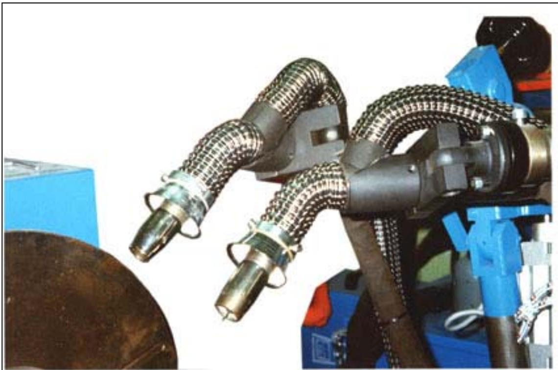
Trasformazione, con l'applicazione del sistema brevettato **ASPIRMIG**, di un impianto esistente presso il Cliente per la saldatura automatica a tornio del Cliente.
