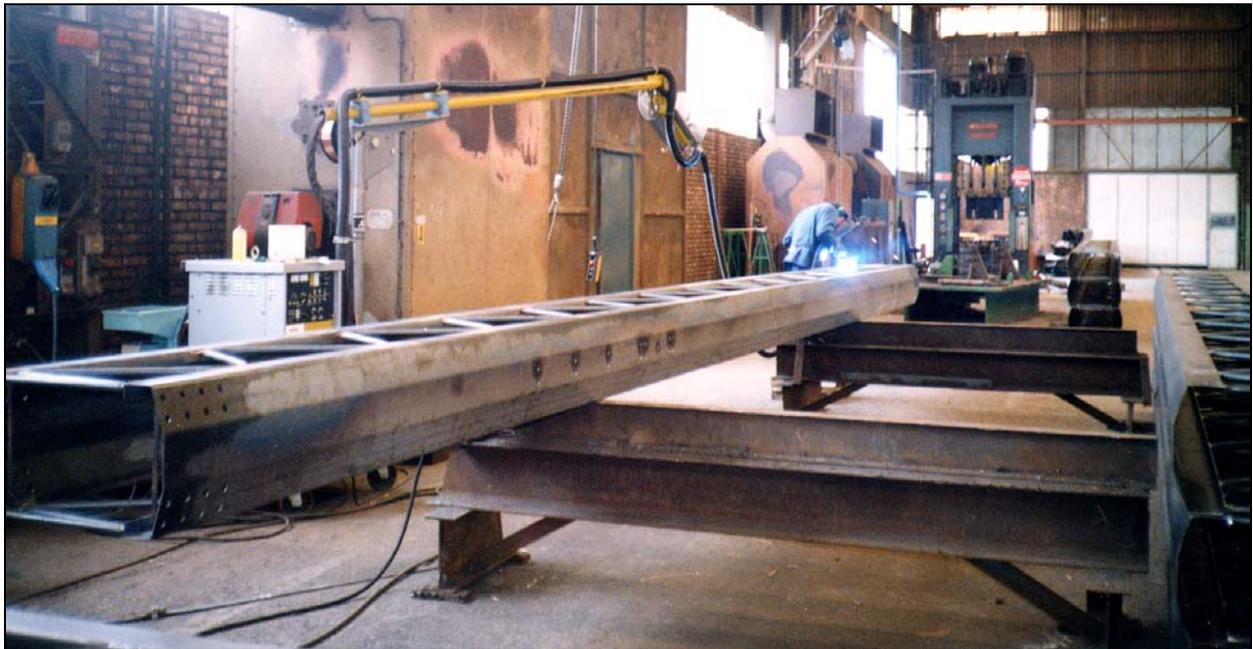
Saldatura di una struttura in opera di circa 15 mt destinata al settore Edilizia Industriale eseguita in totale sicurezza sia per l'igiene che per la Sicurezza fisica, dove cavi, tubi e apparecchiature sono sollevate dal pavimento.
